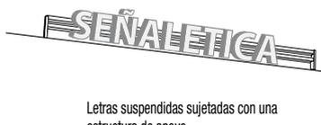
Letras suspendidas sujetadas con una estructura de apoyo
